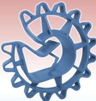
Espaciador circular universal. Con perfil construido de manera a disminuir el contacto del mismo con el molde y el encaje del hierro, dificultando su salida del acero. Su encaje exclusivo tiene un sistema de resorte y contra-resorte que permite un alojamiento perfecto del hierro.
